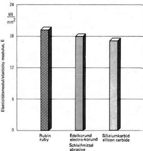
Abb. 4: Elastizitätsmodul von Schleifscheiben mit unterschiedlichem Schleifmittel
