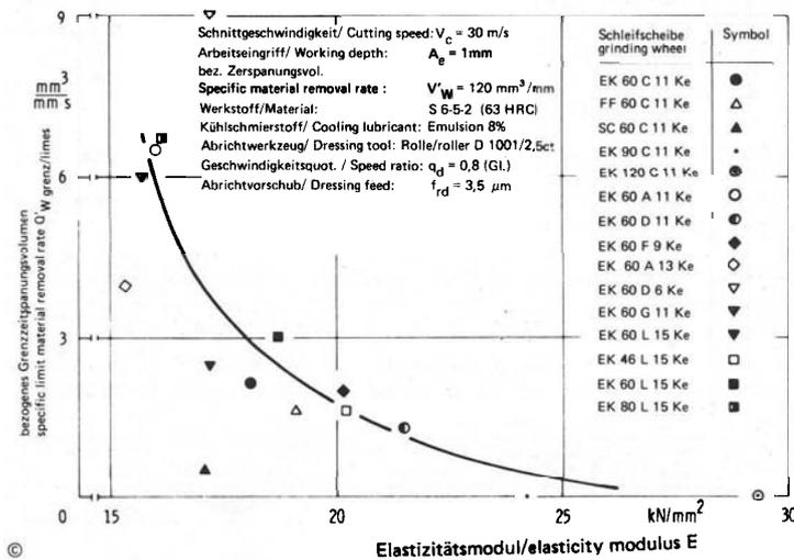
Abb. 15: Einfluß des Elastizitätsmoduls von Schleifscheiben auf das bezogene Grenzzeitspannungsvolumen
