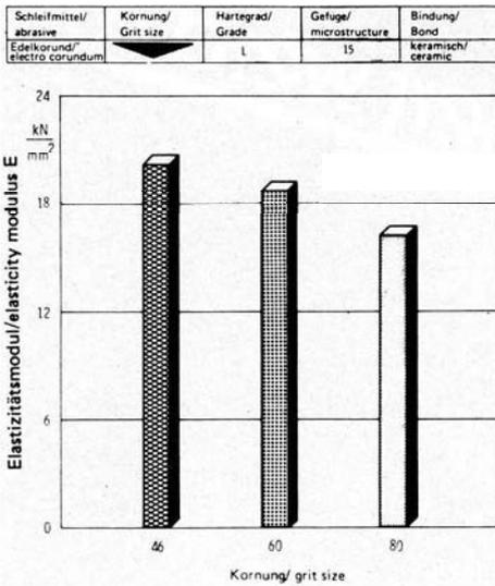
Abb. 7: Elastizitätsmodul von Schleifscheiben unterschiedlicher Körnung
