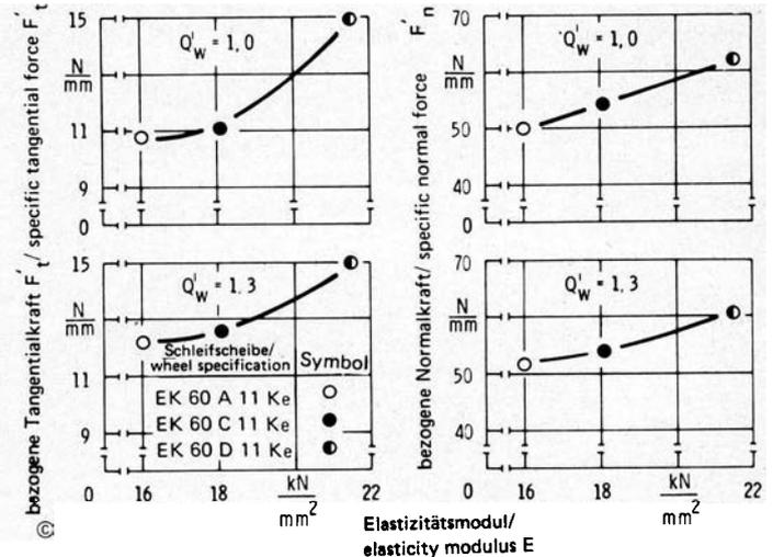
Abb. 10: Einfluß des Elastizitätsmoduls von Schleifscheiben unterschiedlicher Härte auf die bezogenen Schleifkräfte
