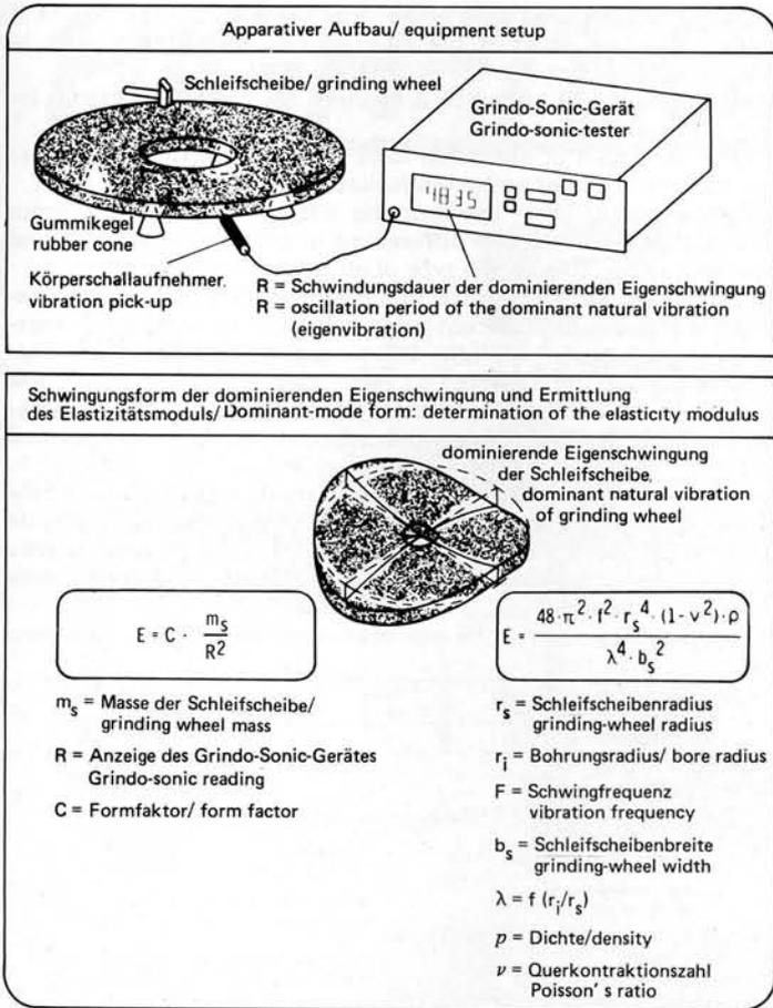
Abb. 1: Bestimmung des Elastizitätsmoduls von Schleifscheiben nach dem Grindo-Sonic-Verfahren
