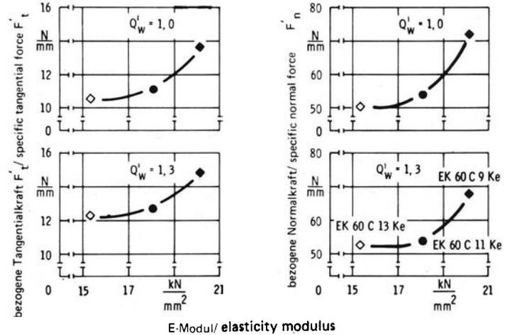
Abb. 12: Einfluß des Elastizitätsmoduls von Schleifscheiben mit unterschiedlichem Gefügebau auf die bezogenen Schleifkräfte
