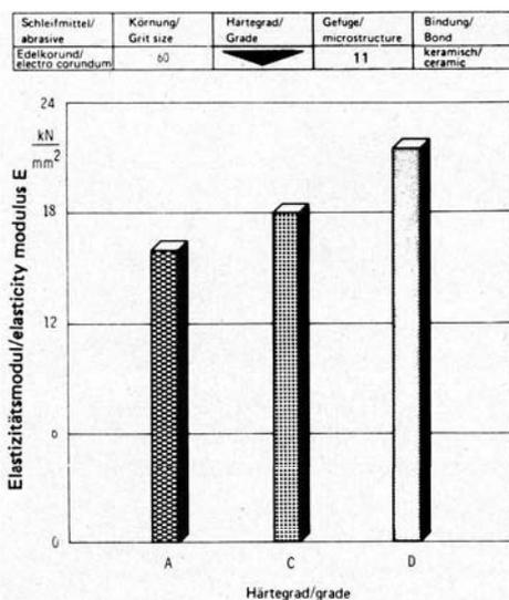
Abb. 9: Elastizitätsmodul von Schleifscheiben unterschiedlichen Härtegrades
