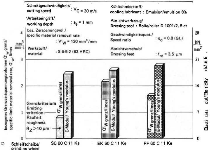
Abb. 5: Bezogenes Grenzzeitanspannungsvolumen und Elastizitätsmodul von Schleifscheiben mit unterschiedlichen Schleifmitteln
