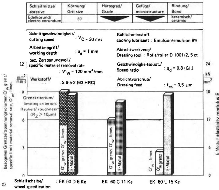
Abb. 14: Bezogenes Grenzzeitspannungsvolumen und Elastizitätsmodul von Schleifscheiben mit extrem unterschiedlicher Zusammensetzung
