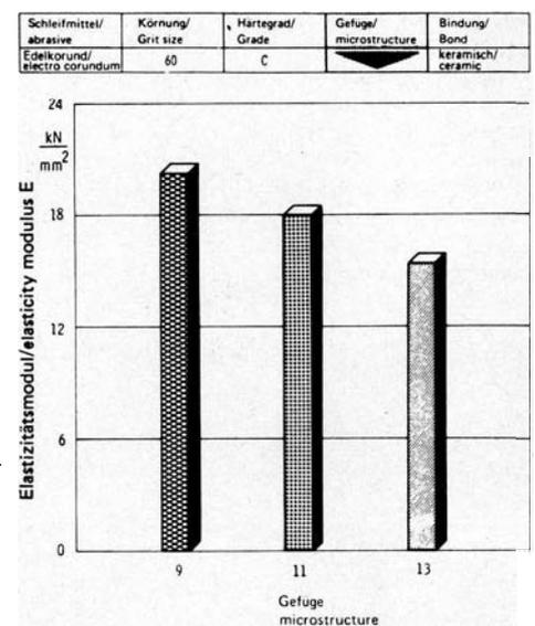
Abb. 11: Elastizitätsmodul von Schleifscheiben mit unterschiedlichem Gefüge
